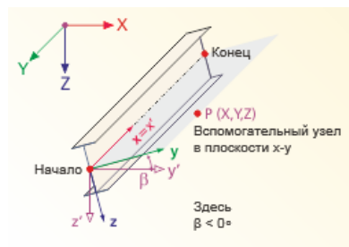
Рисунок 4.157: Вращение стержня и местные оси стержня x, y, z (любое пространственное положение)
